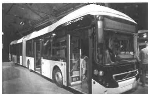
Figură 3-23 Autobuzul Volvo 7900 Hybrid (PHEV) cu posibilitatea de încărcare a bateriilor
