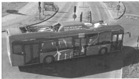
Figură 3-23 Autobuzul Volvo 7900 Hybrid (PHEV) cu posibilitatea de încărcare a bateriilor
